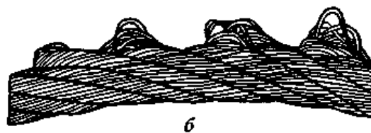
Рисунок 19 – Выдавливание проволок прядей: а — в одной пряди; б — в нескольких прядях
