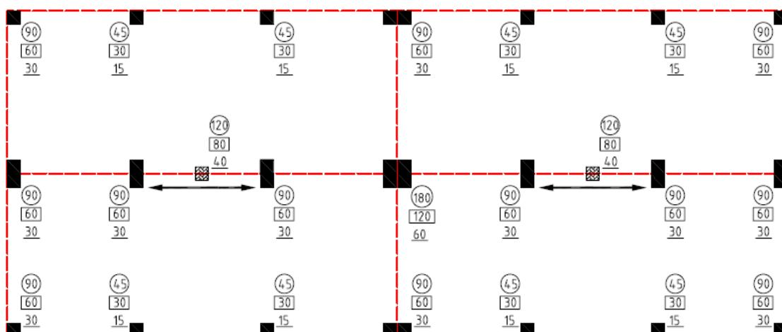
Дополнительная точка фундамента для опорной стойки (необходима только при открытых продольных соединениях).
