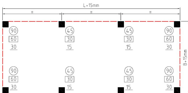
Нагрузка на фундамент для 3-х этажных модульных зданий:
