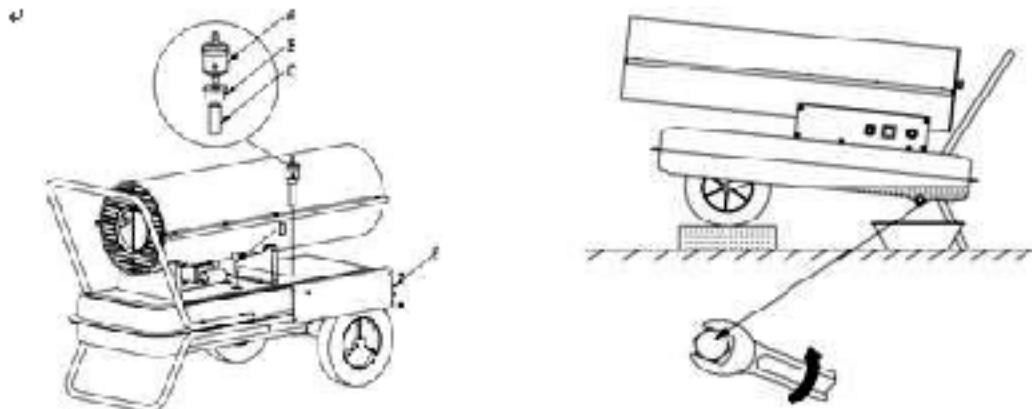
А - фильтр, В - заглушка, С - прозрачная трубка, Д - вводная трубка, Е - боковая пластина
