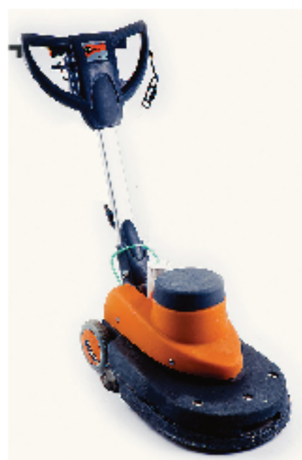
Шлифовальная машина Для шлифовки основания.
